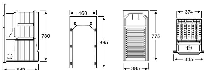
Alle Leistungsgrößen können mit Anbauleisten für die Frontplattenabmessungen 895 mm × 470 mm und 830 mm × 480 mm ausgestattet werden.
