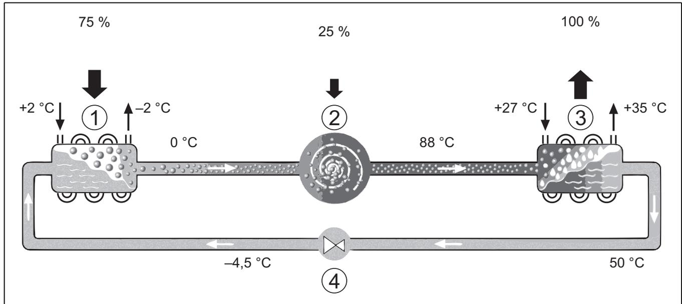
Bild 5 Funktionsprinzip des Kältemittelkreises in der Außeneinheit
