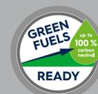
Mit dem „Green Fuels Ready“-Produktlabel kennzeichnen Hersteller Produkte wie z. B. Öl-Brennwertkessel, Tanks und andere Komponenten einer Ölanlage, die für treibhausgasneutrale flüssige Brennstoffe (= „Green Fuels“) und beliebige Mischungen mit fossilen flüssigen Brennstoffen geeignet sind. Konkrete Beispiele dafür sind rein paraffinische Heizöle (z. B. HVO) und Mischungen von mineralischen Heizölen mit Biokomponenten (z. B. FAME).
