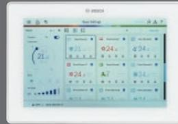
ACC MT – Zentralregler mit Touch-Display und WLAN-Anschluss
