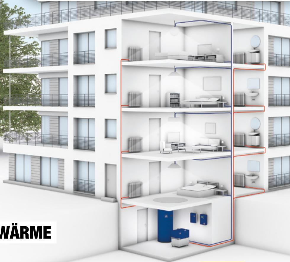
Ein Brennstoff wird in einem Verbrennungsmotor verbrannt. Die bei diesem Prozess frei werdende Bewegungsenergie treibt einen Generator an, der Strom erzeugt. Die dabei entstehende Wärme fängt das XRGI® in einem Wärmetauscher ein und überführt sie in den externen Kreislauf als Heizwärme und für die Warmwasserbereitung. Die eingesetzte Primärenergie wird somit bis zu über 96% genutzt. Dieser hohe Wirkungsgrad macht das XRGI® so effizient.
