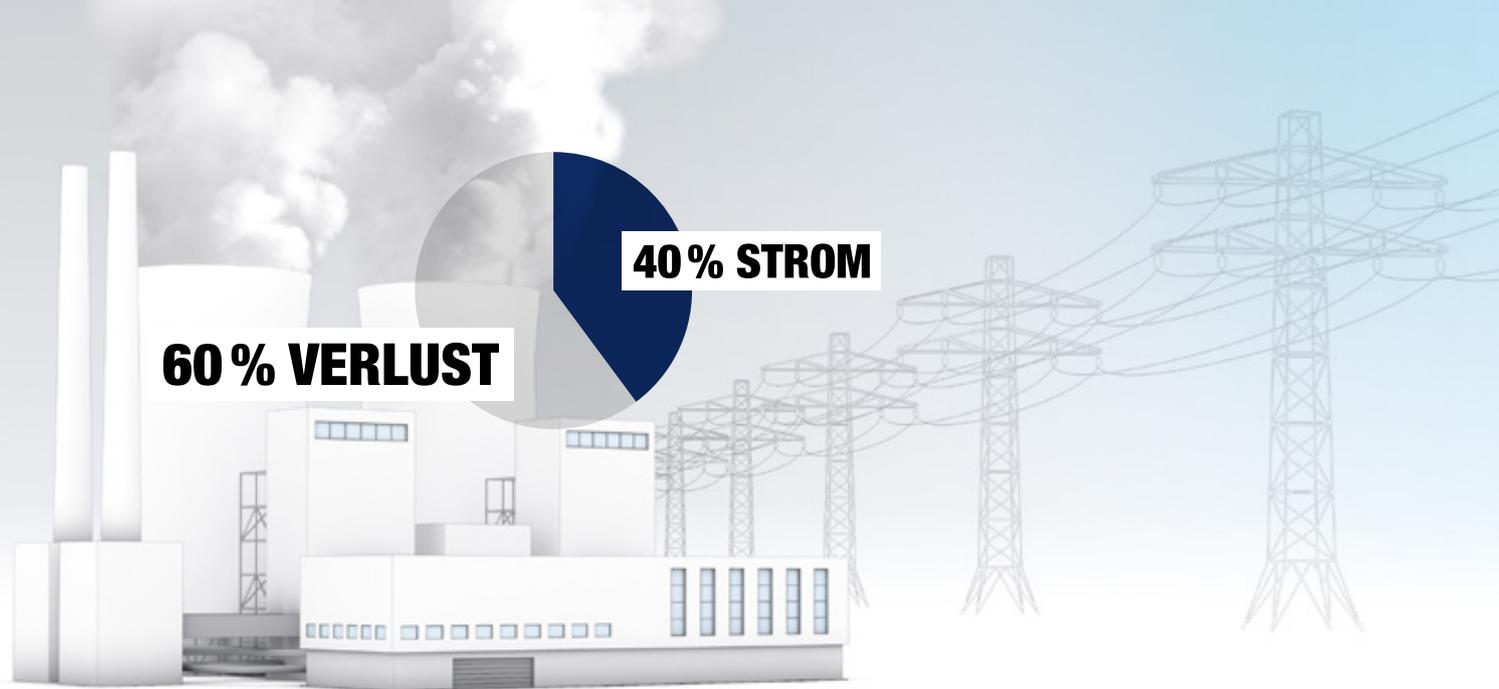
Konventionelle Großkraftwerke nutzen nur rund 40% des eingesetzten Brennstoffes, weil sie nur Strom gewinnen. Die dabei entstehende Wärme (Abwärme) wird ungenutzt und mit schädlichen Folgen in die Umwelt abgegeben.
