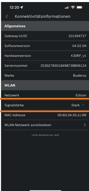
5. Überprüfen Sie die WLAN-Signalstärke nach dem Abschluss der Inbetriebnahme (Menü: ☰, dann „Konnektivitätsinformationen“).
