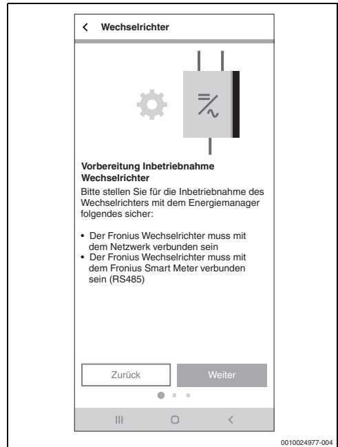
Bild 22 Fronius Wechselrichter verbinden
