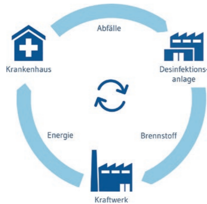
Mehr Kreislaufwirtschaft – zusätzliche CO 2 -Reduktion: Anders als beim bisherigen Standard können mit Hilfe von REKOMED Krankenhausabfälle in regulären Verbrennungsanlagen verwertet werden.
