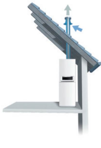
Raumluftunabhängige Aufstellvariante mit Rohr-in-Rohr-Kunststoff-Abgassystem
