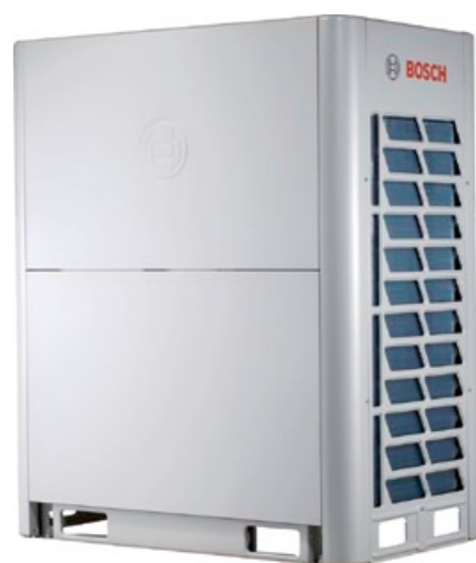
Heizen, Kühlen und Warmwasser: VRF-Klimasysteme sind Alleskönner. Sie bestehen aus je einer Außeneinheit und bis zu 64 Inneneinheiten und arbeiten nach dem Prinzip einer Luft-Luft-Wärmepumpe.
